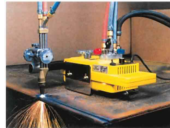
Резка по направляющей
