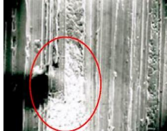
Сталь марки 254 SMO обработана кругом с абразивностью 120 grit. На необработанной части можно видеть щелевую коррозию.
