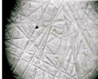
Сталь марки 254 SMO, обработанная кругом с абразивностью 360 grit.
