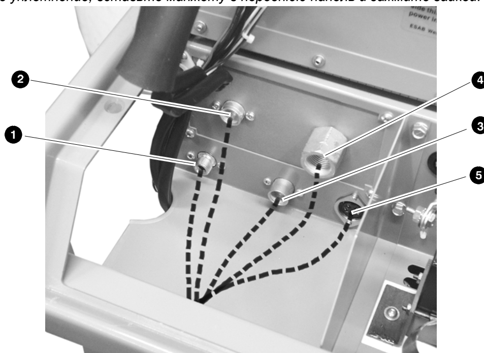
Рис. 8. Если выполняется механическая работа с защищенной прямой горелкой, удалите резиновое уплотнение, вставьте манжету в переднюю панель и зажмите гайкой.
