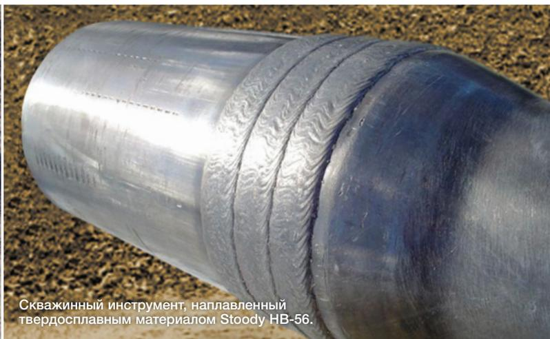
Скважинный инструмент, наплавленный твердосплавным материалом Stoodu HB-56.
