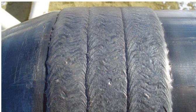
**Профиль шва может быть настроен смещением горелки.**
