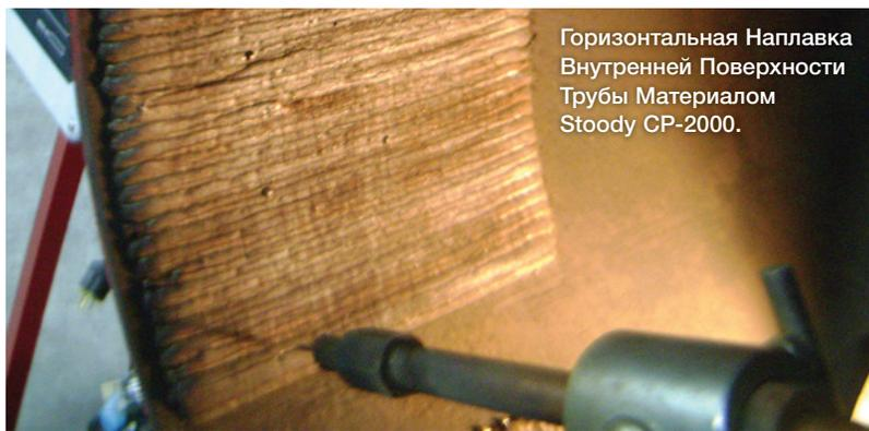
Горизонтальная Наплавка Внутренней Поверхности Трубы Материалом Stoody CP-2000.
