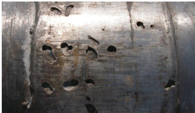
**Неприемлемо для Повторной Наплавки**
