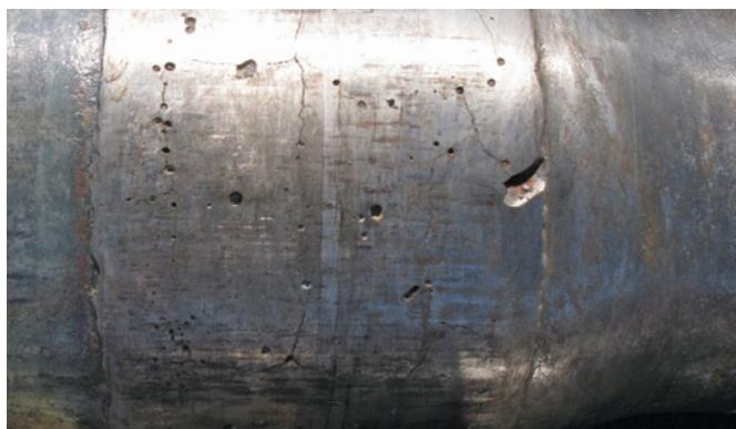
**Неприемлемо для Повторной Наплавки**
