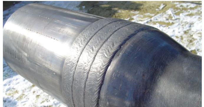
**Пример Приемлемой Наплавки после Сварки**
