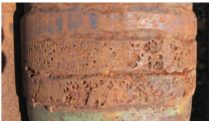
**Неприемлемо для Повторной Наплавки**
