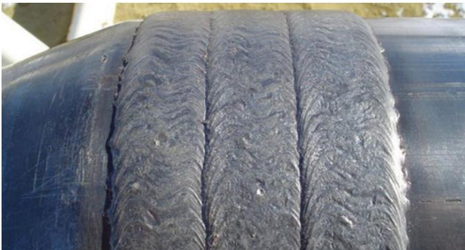
**Профиль шва может быть настроен смещением горелки.**
