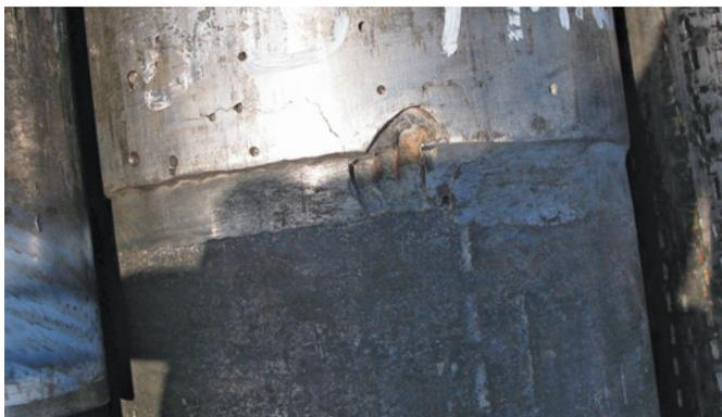
**Неприемлемо для Повторной Наплавки**
