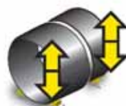
Соединение секций трубы с использованием роликовых опор с гидравлической системой стыковки. Внутренняя и наружная дуговая сварка под флюсов, выполняемая системой колонны со стрелой.
