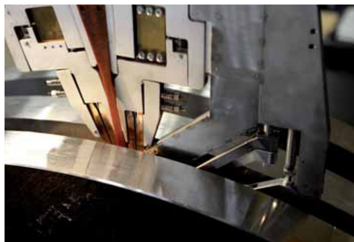
Двухстороннее слежение по стыку
