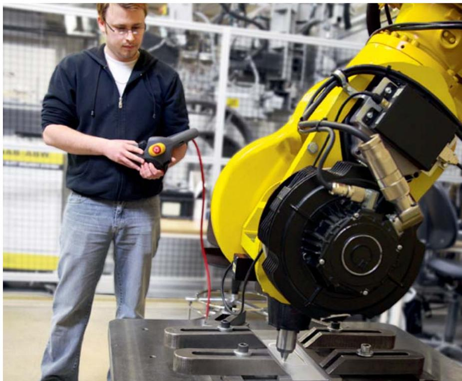
Рис. 1. Сварочные испытания, проводимые на FSW- сварочном аппарате Rosio™.
