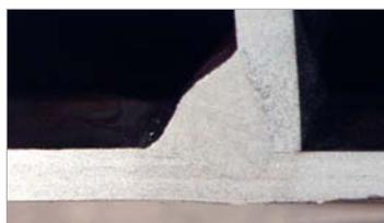
Сечение таврового сварного шва - лист 2.0 мм, сварка в защитном газе Ar/8% CO<sub>2</sub>.
