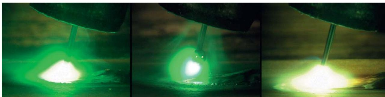
Aristo SuperPulse – результат дальнейшего развития концепции «импульс/импульс», обеспечивающий полный контроль тепловложения, что позволяет расширить сферу применения процесса MIG. В дополнение к режиму «импульс/импульс», возможны следующие сочетания и сферы применения:
