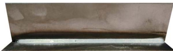
Тавровый сварной шов - лист 2.0 мм, сварка в защитном газе Ar/8% CO<sub>2</sub>. Длина 20 см.
