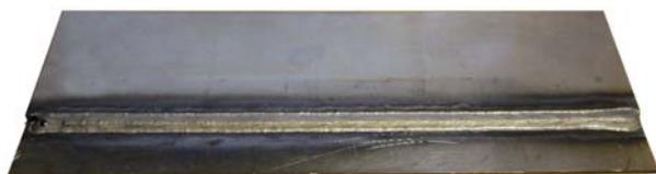
Нахлесточный сварной шов - лист 2.0 мм, сварка в защитном газе Ar/8% CO<sub>2</sub>. Длина 20 см.
